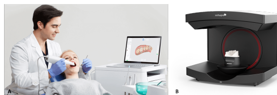
Imagem A: Escâner intraoral Imagem B: Escâner de bancada Fonte: Dentaltix Fonte: 3Shape
