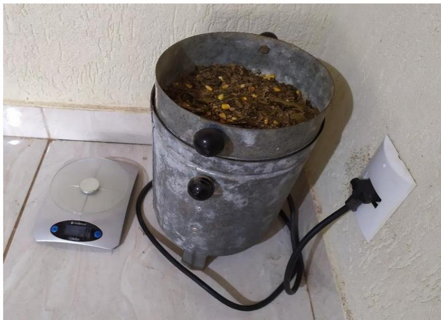
**Figura 2.** Medidor de umidade Koster.
